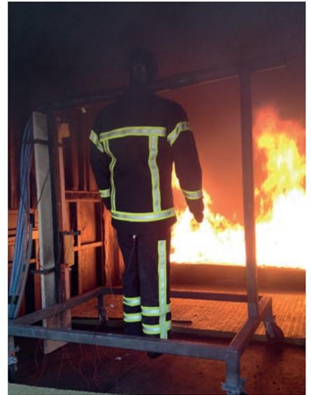
*Equipement de protection individuel instrumenté pour mesurer les échanges thermohydriques*
