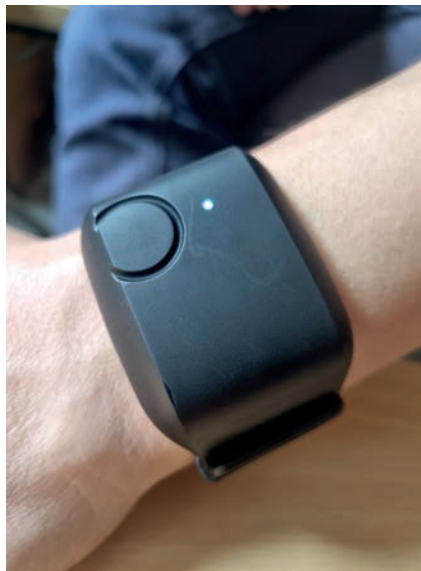
Bracelet EMPATICA pour mesurer les paramètres physiologiques en temps réel
