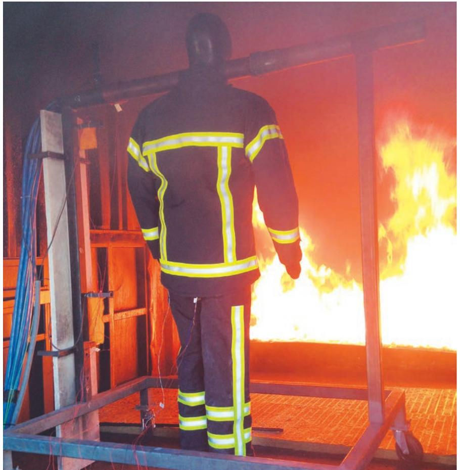
Equipement de protection individuel instrumenté pour mesurer les échanges thermohydriques
